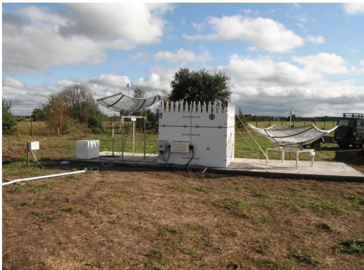
Рисунок 8.6– Измерительный комплекс SODAR
